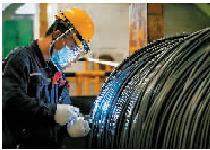
《把关》 2024年1月13日,天津市新天钢集团盘条车间的检验员在刚刚出炉的滚烫盘条前,用手中的检验仪器认真测量。 李跃敏摄
