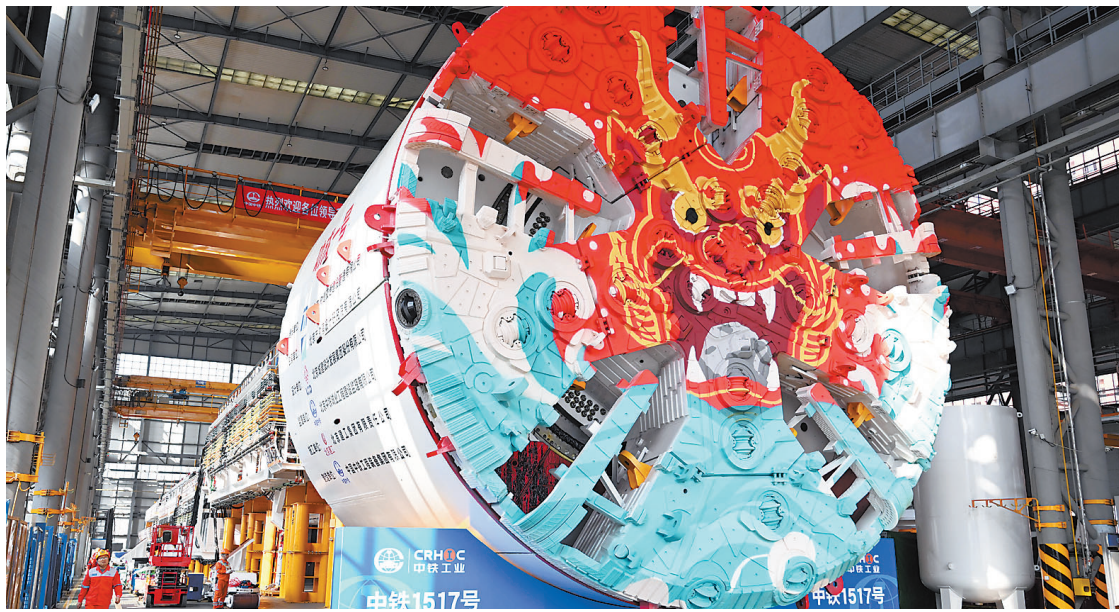
11月3日,工人在郑州的中铁装备集团车间进行盾构机下线验收工作。 新华社记者 李嘉南 摄
