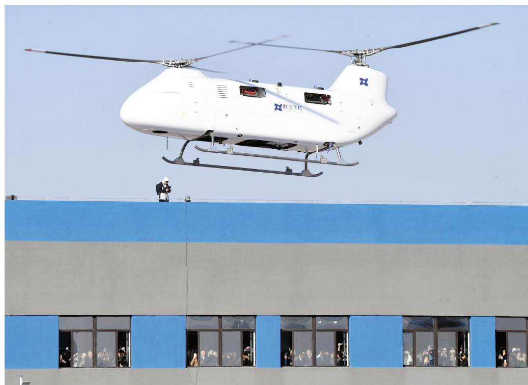
10月30日,哈尔滨联合飞机科技有限公司研发制造的铂影T1400纵列式无人直升机在哈尔滨完成首航。据悉,该无人机最大起飞重量达1400公斤、最长续航8小时、升限6500米、最大平飞速度180千米/小时,采用双发动机、冗余度飞控系统和高强度复合材料结构,拥有超大载荷和空间设计,具备智能化和自主作业能力,在农林植保、物流运输、森林防火等领域有广阔应用前景。
