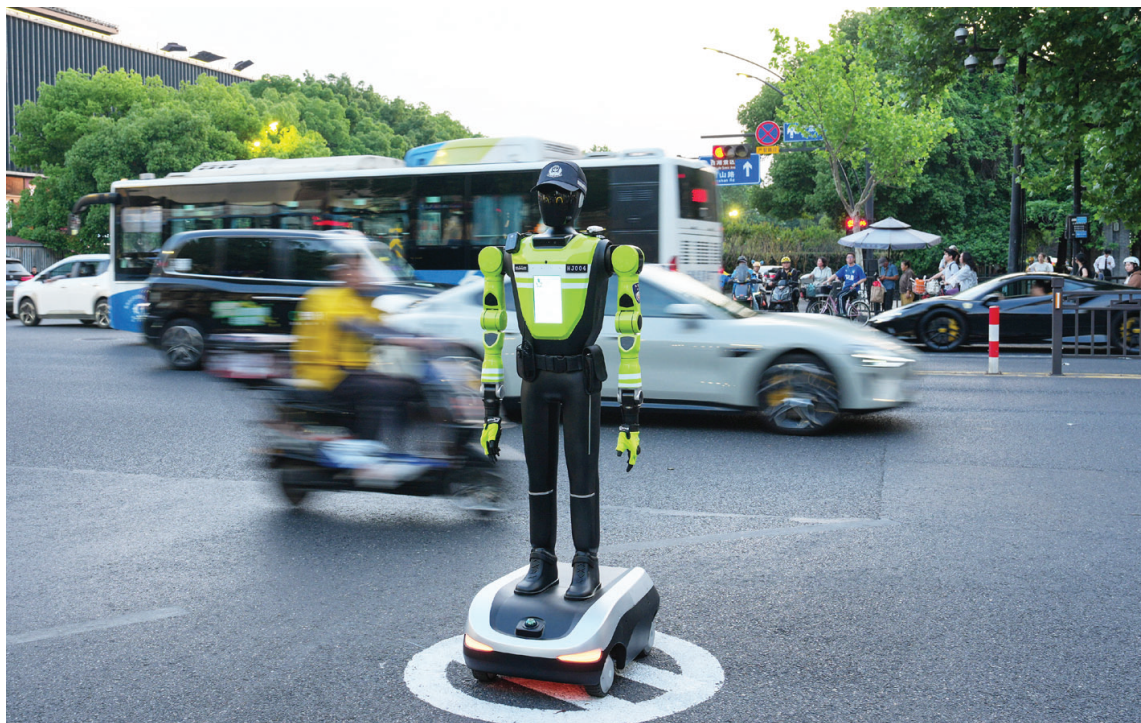
5月11日,智能交通管理机器人在杭州湖滨商圈一路口“执勤”。机器人将根据各路口不同场景和功能需求,承担游客问路指引、非机动车和行人违法劝导、交通指挥等任务。新华社记者 黄宗治 摄
