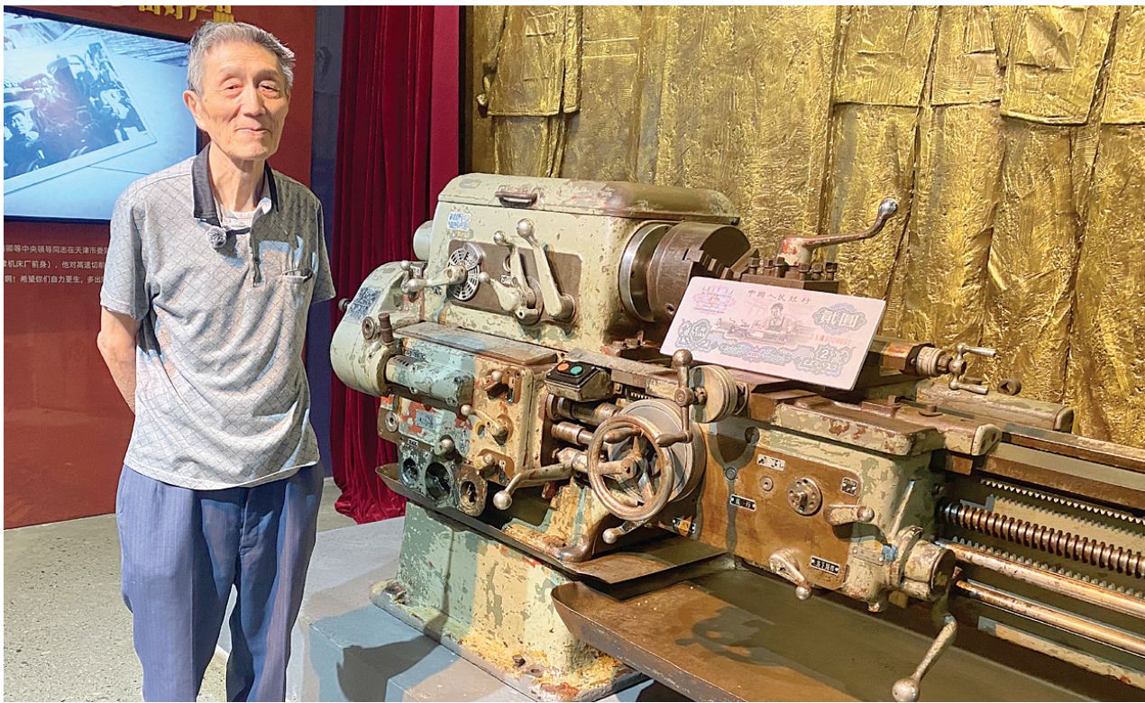
84岁的陈恭樊与C620全齿轮传动车床,这是我国第一台仿苏1A62全齿轮传动车床。
